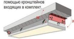
Монтаж на шинпровод (всех типов и производителей).
